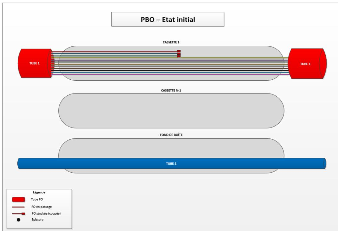
2. Fenêtrer le tube en utilisant l'outillage adapté (ne pas faire avec les doigts) et en veillant à ne pas couper d'autres fibre que celle devant être utilisé pour le raccordement.
