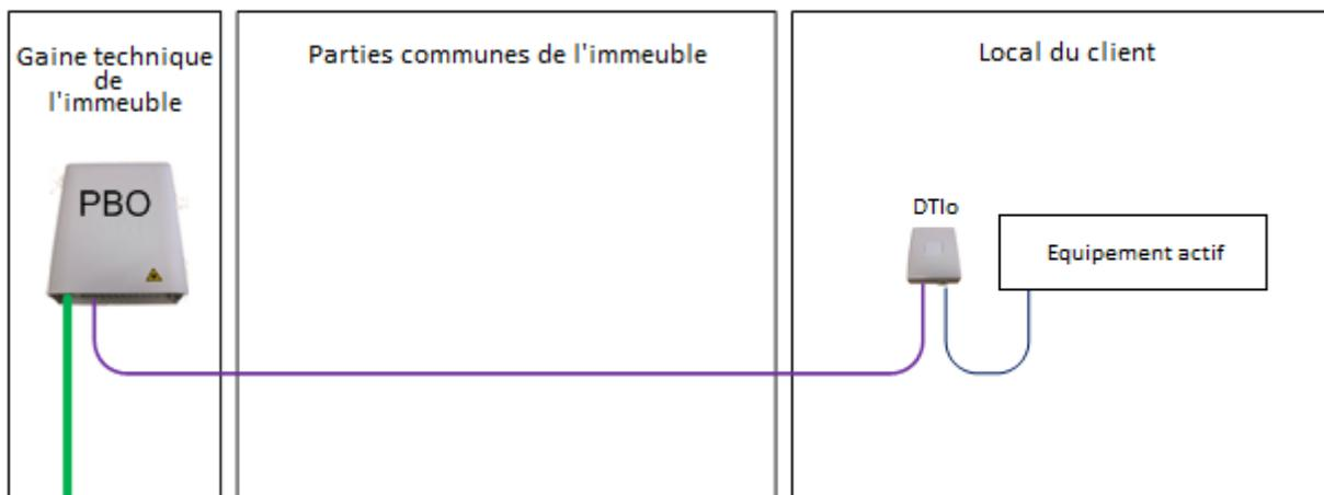
Le passage du câble optique, entre le PBO et le DTIO est fonction de l'implantation du PBO. Il peut être réalisé de trois manières :
