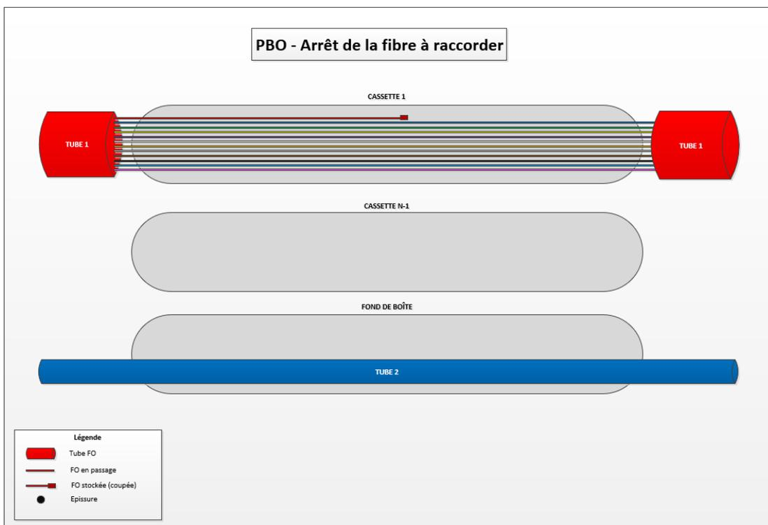
4. Procéder à l'épissure avec la fibre utile du câble abonné et positionner le smooove dans la même cassette.
