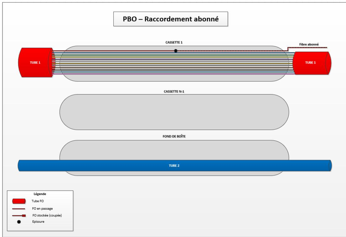
En cas de mauvaise manipulation et de rupture de fibres non concernées par le raccordement, sur le tube fenêtré, l'intervenant devra procéder aux épissures nécessaires pour rétablir la continuité.
