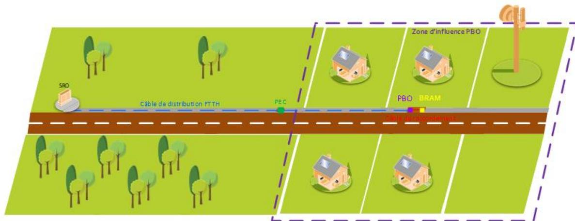
Ce boîtier sera positionné dans le réseau d'infrastructure existant à proximité immédiate du PBO, dans la même chambre ou sur le même appui. La distance entre le PBO et le BRAM ne devra pas excéder 1 mètre.
