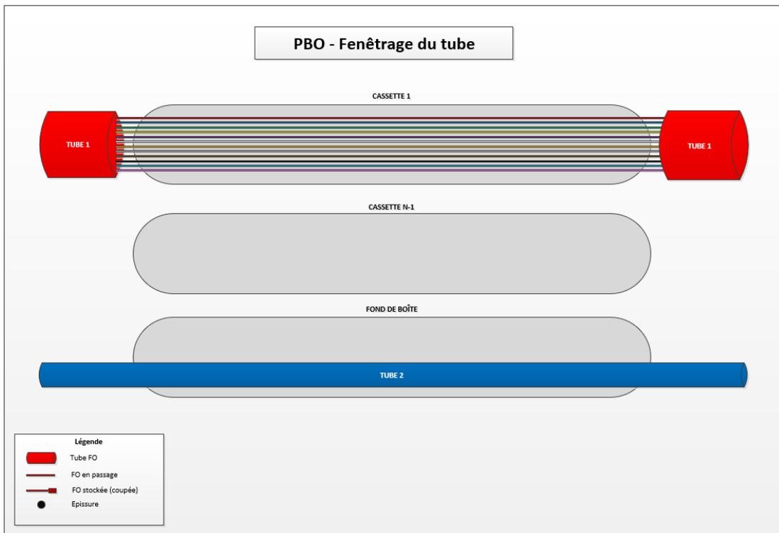
3. Identifier la fibre à utiliser en fonction des informations transmises par l'opérateur d'immeuble et l'arrêter dans la cassette.
