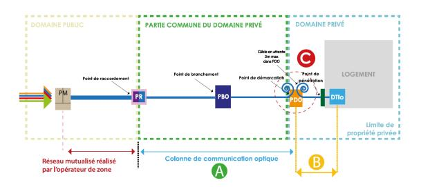
La réalisation de la colonne de communication optique (le A du schéma) relevant du lotisseur/aménageur va permettre l'accès du domaine privé du particulier. Celle-ci doit être réalisée selon les règles d'ingénierie de l'opérateur de zone Rosace.
